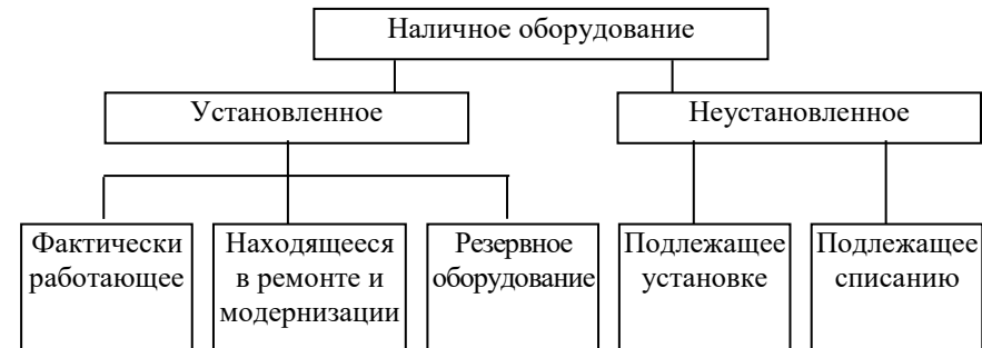
Рис. 2. Состав наличного оборудования
